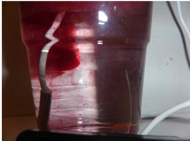
Glasboden eine scharfe rote Linie von ca. 1 mm Höhe. Nach 10-15 Minuten beginnt eine sichtbare Diffusion des roten Farbstoffs von unten nach oben. Die Höhe der Farbschicht nimmt zu und ist oben heller. Beim diesem Versuch lässt sich gut das Wissen zur Diffusion reaktivieren. Weitere Ergebnisse als Beispiel in der Tabelle.
